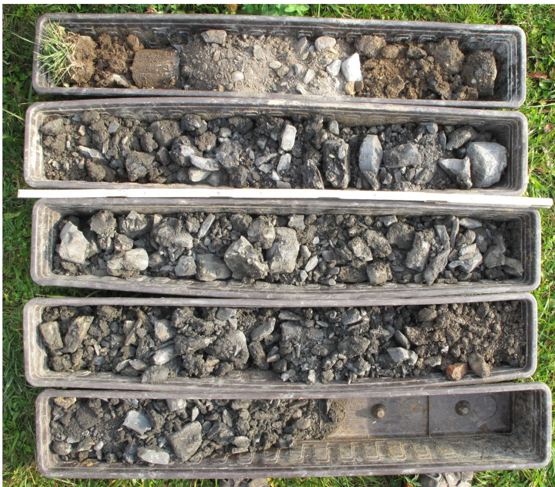
Obrázek č. 9: Vrtné jádro z vsakovací sondy H3
