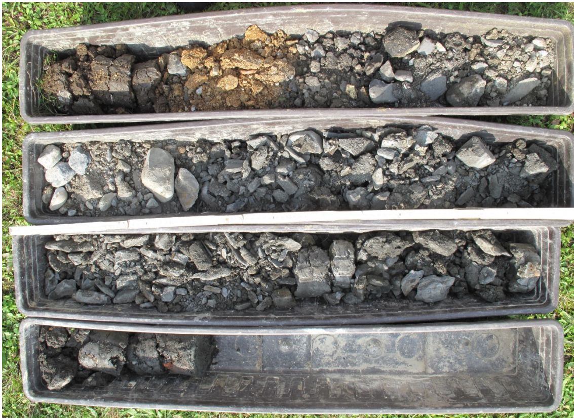
Obrázek č. 7: Vrtné jádro z vsakovací sondy H2
