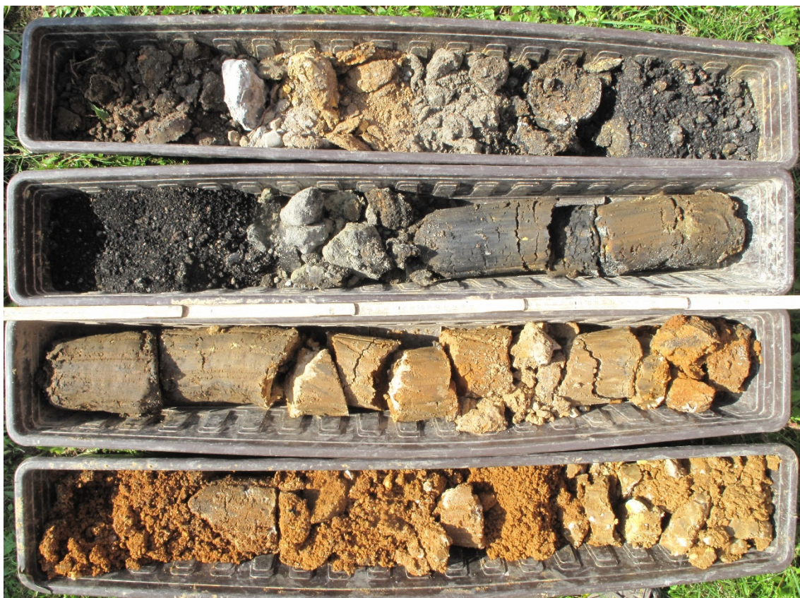
Obrázek č. 5: Vrtné jádro z vsakovací sondy H1
